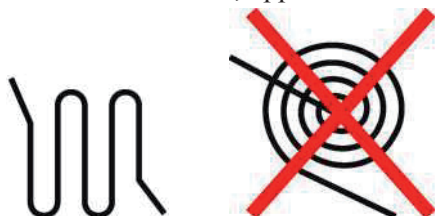
Figur 2-1 Rekommenderad hantering av överskjutande kabellängd.
