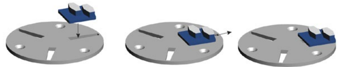
Figur 4-3 Hur man fäster slipsegmenten på Scan-On-fästskivan
