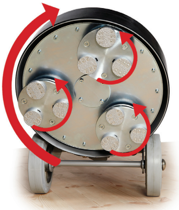
Figur 41 Illustrerar sliphuvudernas rotation i förhållande till växelhuset.
